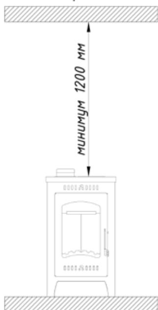
*Схема монтажа печи-камина от потолка из негорючего материала*
